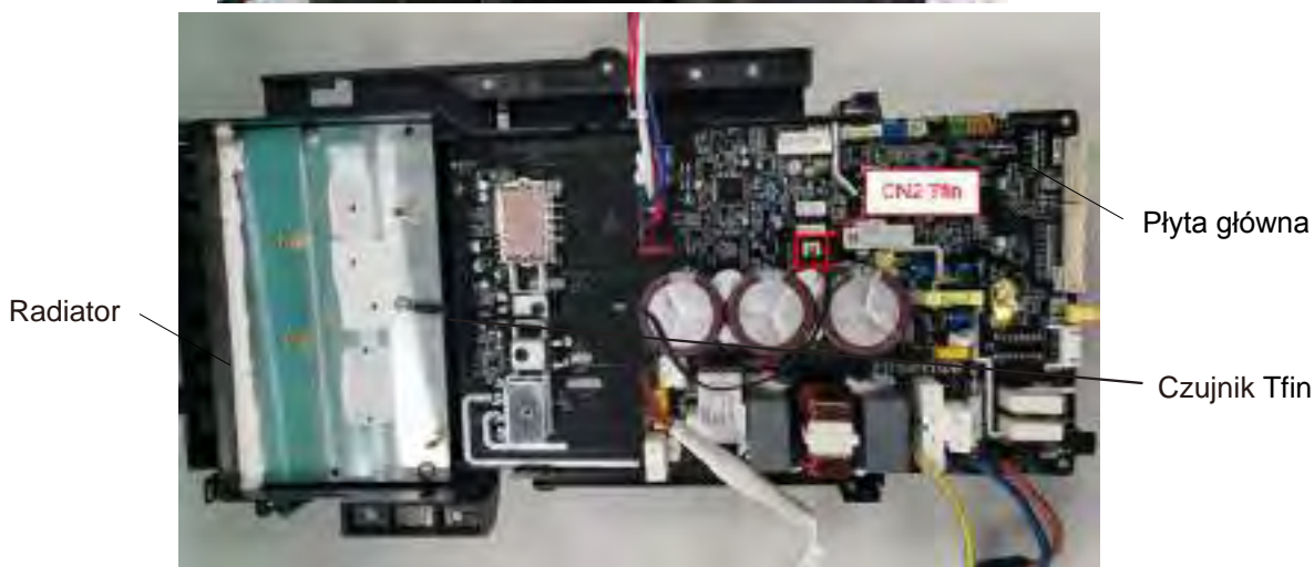
Rys.2.17 Wymiana płyty głównej i radiatora
