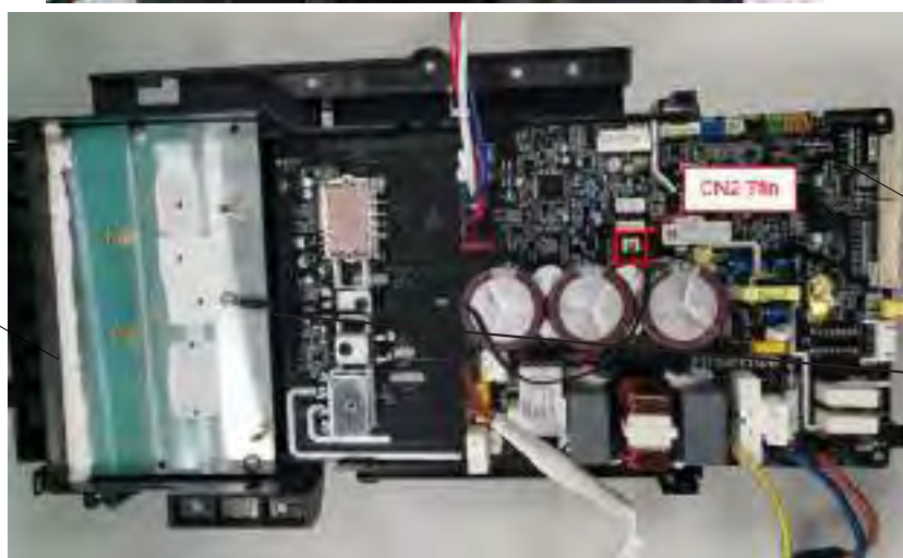
Rys.2.21 Wymiana płyty głównej i radiatora
